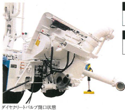
ダイヤクリートバルブ開口状態
